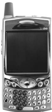
Рис. 9.8. Palm Treo 650 предлагает аппаратные кнопки для переключения между режимами (заметьте, что кнопки календаря и электронной почты расположены по обе стороны от джойстика)
