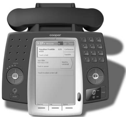
Рис. 9.7. Дизайн компании Соопер для интеллектуального телефона, демонстрирующий высокую степень интеграции аппаратных и программных элементов управления. Пользователь может легко настраивать громкость динамика, набирать телефонные номера, управлять воспроизведением голосовых сообщений с помощью аппаратных элементов управления, управлять записной книжкой и входящими звонками, вызывать журнал, голосовую почту и устраивать конференции с помощью сенсорного экрана и управляющего колеса. Интерфейс данного аппарата не перегружен функциями, но упрощает доступ к наиболее востребованным и самым важным из них. Обратите внимание на то, что размеры областей сенсорного экрана, к которым нужно прикасаться, соответствуют размеру пальца, а текстовые подсказки облегчают обращение с аппаратом
