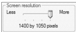
Рис. 21.15. Ограничивающие элементы ввода дают пользователю возможность вводить только допустимые значения. Они не позволят ввести недопустимое значение лишь для того, чтобы потом отклонить его. На этом рисунке показан ограничивающий элемент ввода – ползунок из диалогового окна настройки параметров экрана в Windows XP. Этот небольшой ползунок имеет четыре дискретных положения. При перемещении ползунка слева направо описание под ним изменяется с «800 на 600 точек» на «1024 на 768 точек», далее на «1280 на 1024 точек» и на «1400 на 1050 точек»
