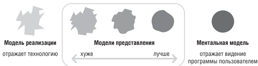
Рис. 2.1. Внутреннее устройство программного обеспечения часто оказывается данностью и продиктовано различными ограничениями технического и делового характера. Модель того, как в действительности работает программа, называется моделью реализации . То, как пользователи воспринимают свои задачи и как программа помогает в решении этих задач, есть ментальная модель взаимодействия с программой. Она основана на представлениях пользователей о том, как они решают свои задачи, и о том, как может работать компьютер. То, как проектировщики преподносят работу программы пользователю, называется моделью представления . В отличие от двух предшествующих моделей, она является тем аспектом программного обеспечения, который в значительной степени поддается контролю со стороны проектировщиков. Одна из важнейших целей проектировщика – максимально приблизить модель представления к ментальной модели пользователей. Таким образом, проектировщикам очень важно детально знать, как целевые пользователи видят работу, выполняемую с помощью программы
